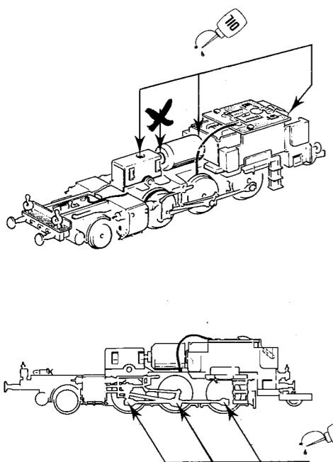
Reinigung der Radstromkontakte:
